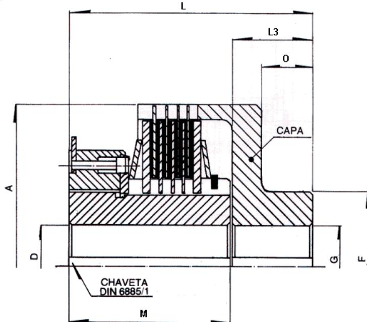
Os limitadores de torque multidisco são aplicados em locais onde se quer proteger o equipamento de choques e sobre-carga, evitando-se, assim, a quebra da transmissão. O torque transmissível em condição normal está indicado na tabela abaixo, podendo haver regulagem para mais ou para menos, sendo que se deve levar em consideração fatores de funcionamento, tais como sobrecarga, características da máquina acionada, tempo de deslizamento, etc.
